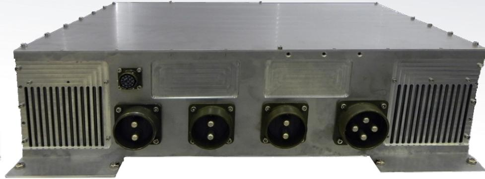
Convertidor AC/DC con entrada del sistema de distribución trifásico del avión y tensión de salida de 270VDC para alimentación del radar y de los sistemas auxiliares de potencia.
