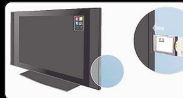
Insertar la tarjeta en el dispositivo CAM y a continuación insertar el dispositivo CAM en la ranura del televisor TDT integrado.
